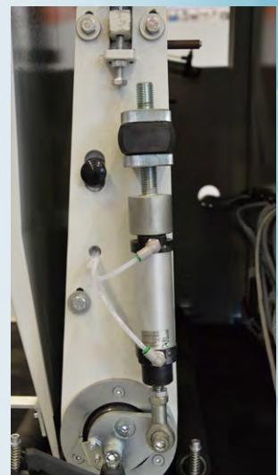
Tensionamento pneumatico del
